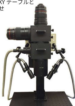
同軸落射照明 + 斜光照明 / 2 波長計測
